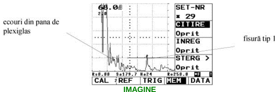
Figura nr. 72 Oscilogramă cu ecou de defect de tip 1 la osii de vagon etajat cu palpator B2S și pană de plexiglas de 13,50^\circ .
